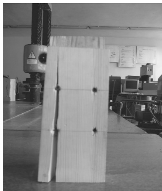
Рис.6. Клеєметалевий зразок після випробування
